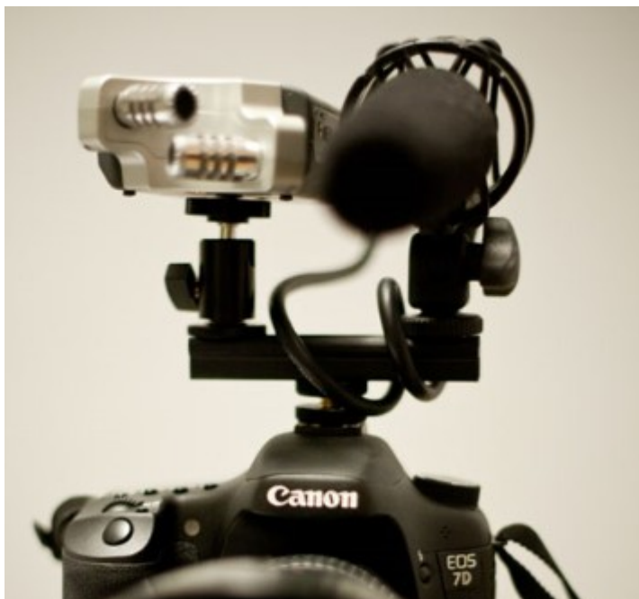
Fig 2 : le zoom H4n sert d'enregistreur au videomic sur le Canon 7D
